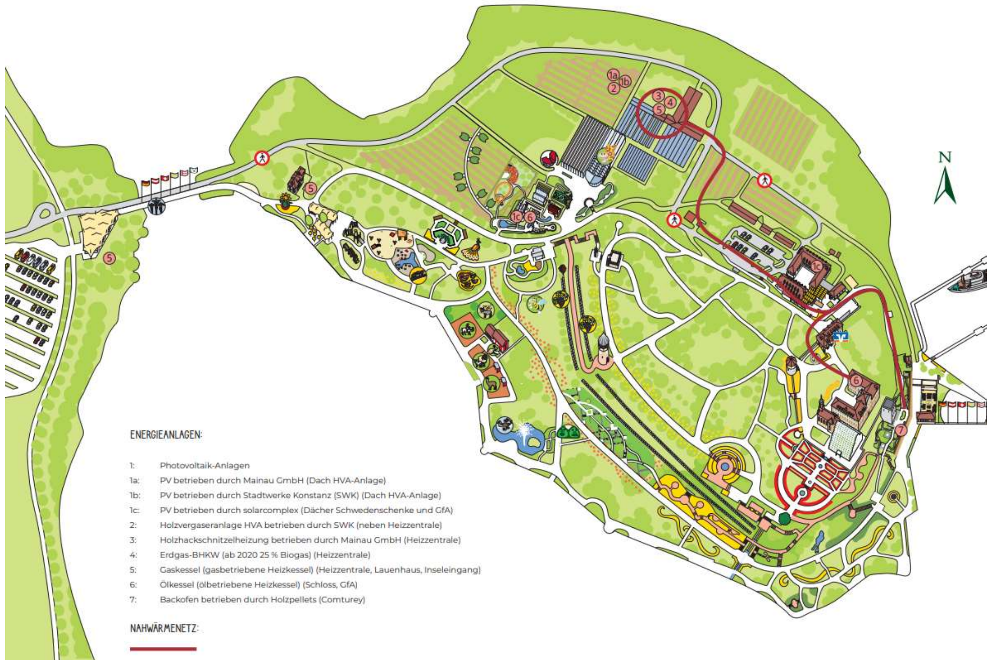
Abbildung 13: Inselplan mit Energieanlagen und Nahwärmenetz
