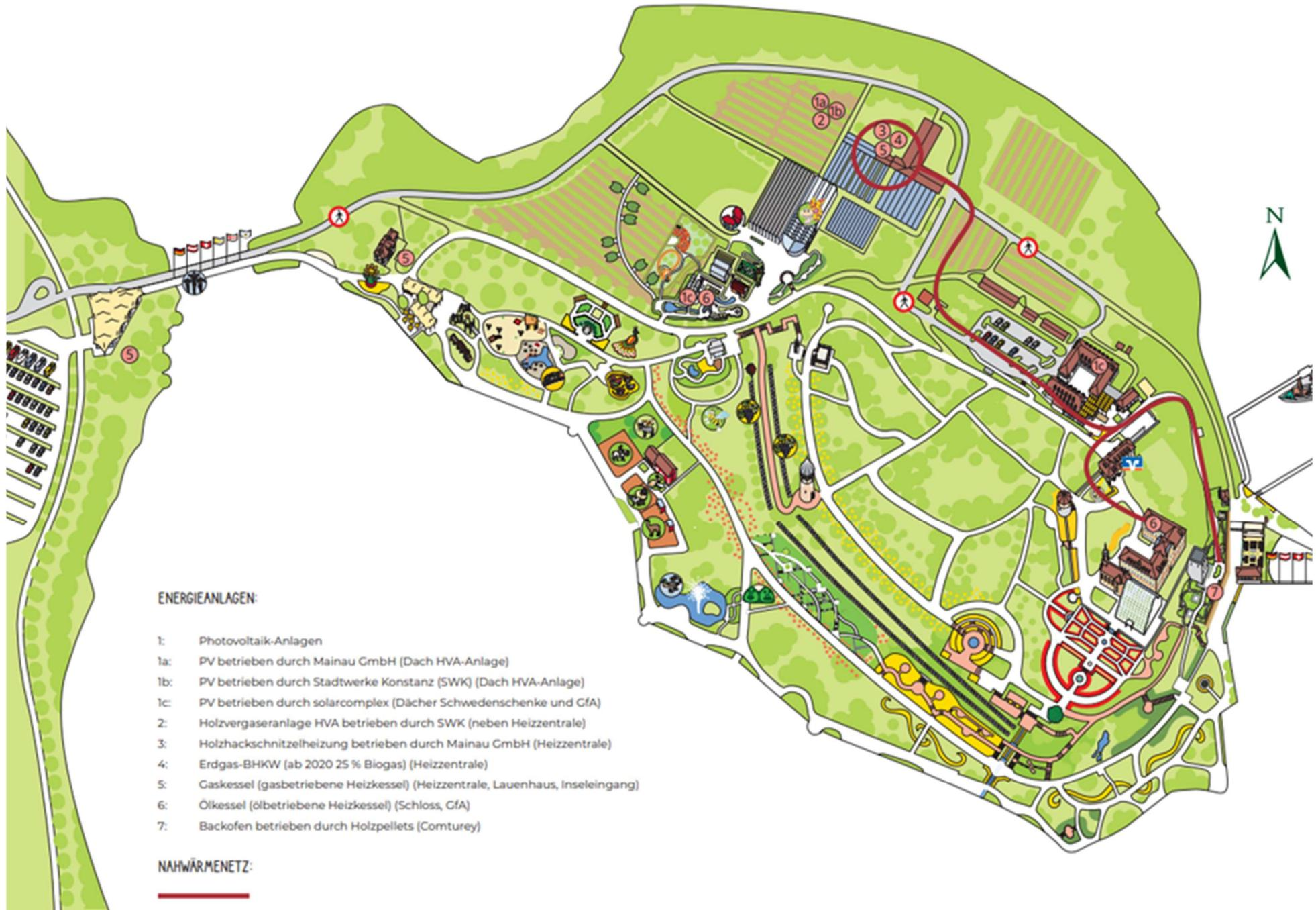
Abbildung 6: Inselplan mit Energieerzeugungsanlagen und Verlauf des Nahwärmenetzes
